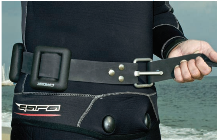
Los remaches sobredimensionados impiden que el cinturón se pueda soltar.
